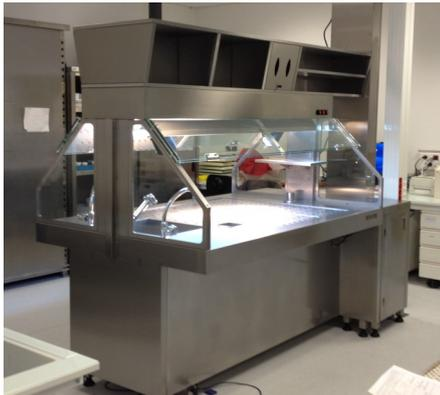
**Partie basse** composée de placards ventilés avec portes en retrait de 230 mm pour le positionnement des jambes. **Partie haute** avec Ventilation frontale par plenum perforé, Eclairage par néon « lumière du jour », Confinement complet de la zone de travail en verre sécurit 8 mm avec volet rabattable sur charnières. **Ventilation** : Vitesse d'aspiration au niveau de l'ouverture en façade = 0,5 m/s. Piquage de raccordement diamètre 200 à 250 mm au dessus du plénum (ou sur coté droit ou gauche)
