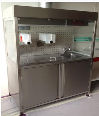
**Partie basse** composée de placards ventilés pour le stockage des bidons de récupération. **Partie haute** avec Ventilation frontale par plenum perforé, Eclairage par néon « lumière du jour », Confinement complet de la zone de travail en verre sécurit type hotte. **Ventilation** : Vitesse d'aspiration au niveau de l'ouverture en façade = 0,5 m/s. Piquage de raccordement diamètre 200 à 250 mm au dessus du plénum (ou sur coté droit ou gauche)
