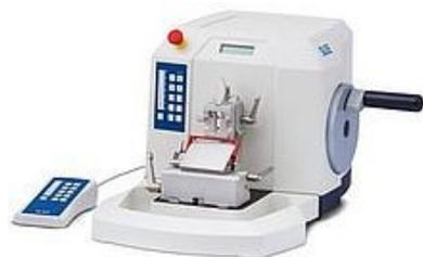
Déplacement latéral précis de la base couteau. Réglages indépendants de la vitesse pour coupe et dégrossissage. 2 Vitesses d'avance de l'échantillon. Mémoire 2 positions de retour porte échantillon. Epaisseur coupe de 0.5 à 100 µm. Epaisseur dégrossissage de 0.5 à 300 µm. Rétraction échantillon. Compteur de coupe. Volant souple et ergonomiques. Alarme fin de course. Grande cuve déchets. Livré avec support lame jetable et pince cassette rapide. Option pupitre déporté
